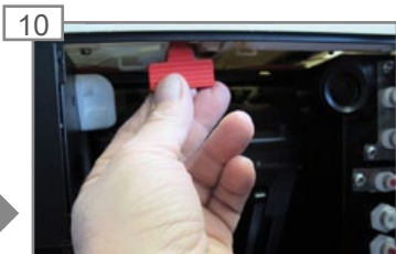
10 Verriegelungsschieber bis zum Anschlag hineinschieben.
