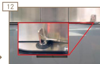
12 Schlüssel des Reinigungsschlosses gegen den Uhrzeigersinn drehen.
