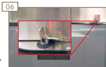
06 Schlüssel des Reinigungsschlosses mit dem Uhrzeigersinn drehen.
